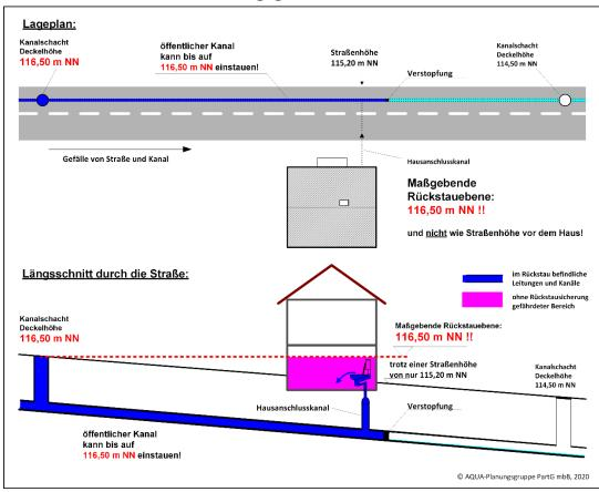
In diesem Beispiel wird die Höhe der Rückstauebene durch die Höhe des bergauf liegenden Kanalschachtes definiert, d.h. dies ist die erste Stelle, an der das Wasser aus dem Kanalnetz auf die Geländeoberfläche austreten kann. Die maßgebende Höhe kann aber auch durch einen an den Kanal angeschlossenen Straßeneinlauf definiert werden, wenn dieser zwischen Anschlussstelle und dem oberhalb liegendem Schacht liegt.
