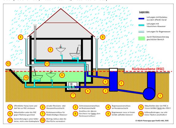
Besser ist der Einbau nur einer automatisch schließenden Sicherung an der Stelle, wo die Grundleitung das Haus verlässt.
