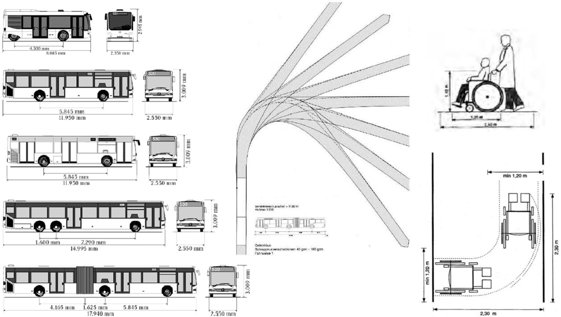
Bild 21: Flächenbedarf für einen Rollstuhl bei Kurvenfahrt
